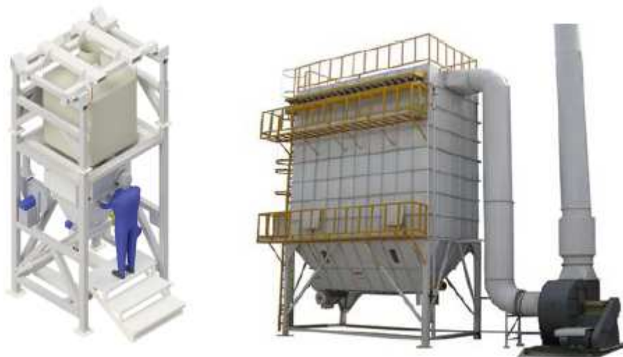
Figure 7 : Vues de filtre à manches (Traitement des effluents gazeux)
