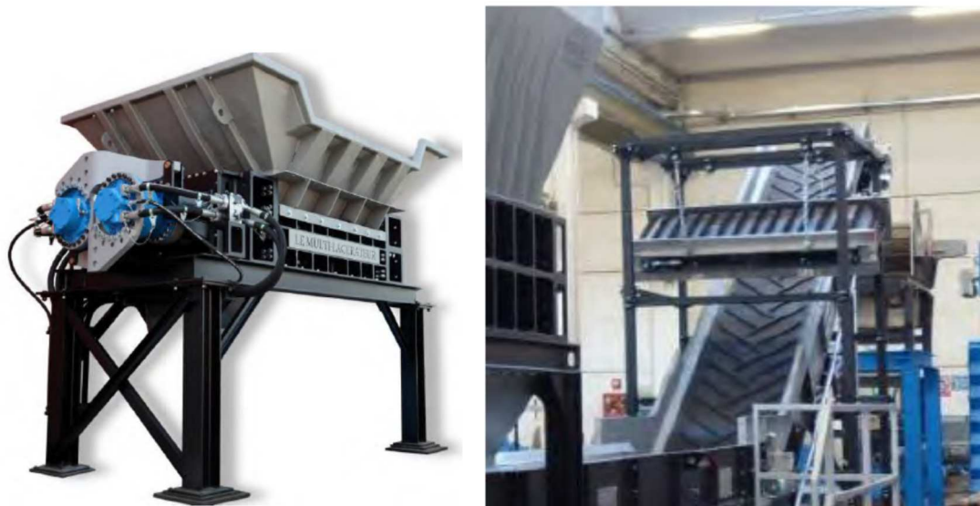
Figure 2 : Images du broyeur primaire et du séparateur magnétique de métaux
